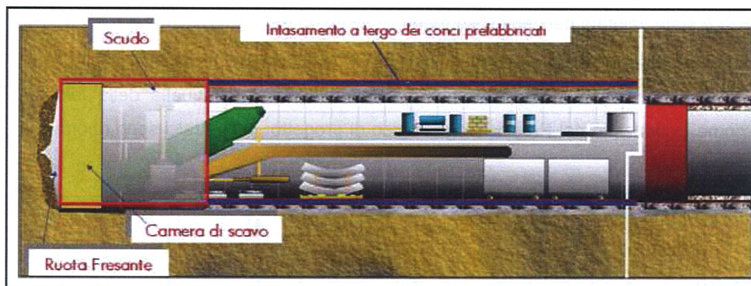
Figura 3.3.1: schema di una TBM-EPB
